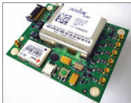
▲ Fig. 1 10 MHz CSAC GPSDO module using a Cesium vapor cell.
